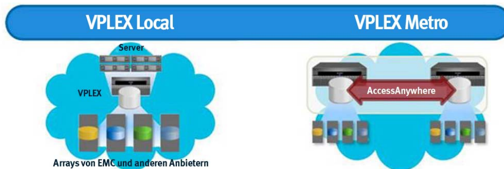
Abbildung 3: Lokaler und verteilter Verbund mit EMC VPLEX Local und VPLEX Metro
