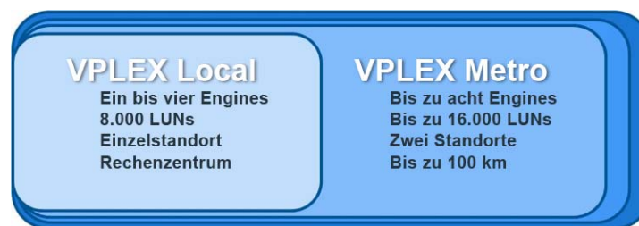
Abbildung 2: Angebot der EMC VPLEX-Produktfamilie mit Architekturgrenzen
